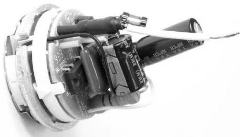
図(a) 大きな電解コンデンサが場所を占めている
