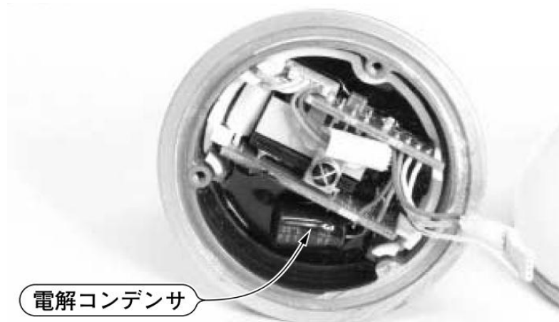
図(b) コンデンサは小さいが大きな空間を必要としている 〈写真1〉市販の電球型 LED 照明具の回路基板の例
