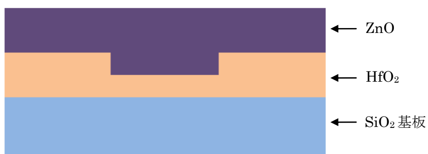
図 1-2 新しく設計した導波路の概略図
