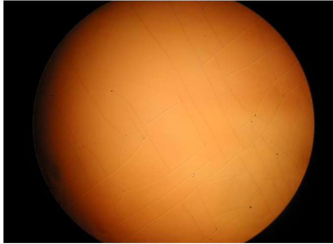
図 5-13 アニール後の Si 基板に成膜した \text{HfO}_2
