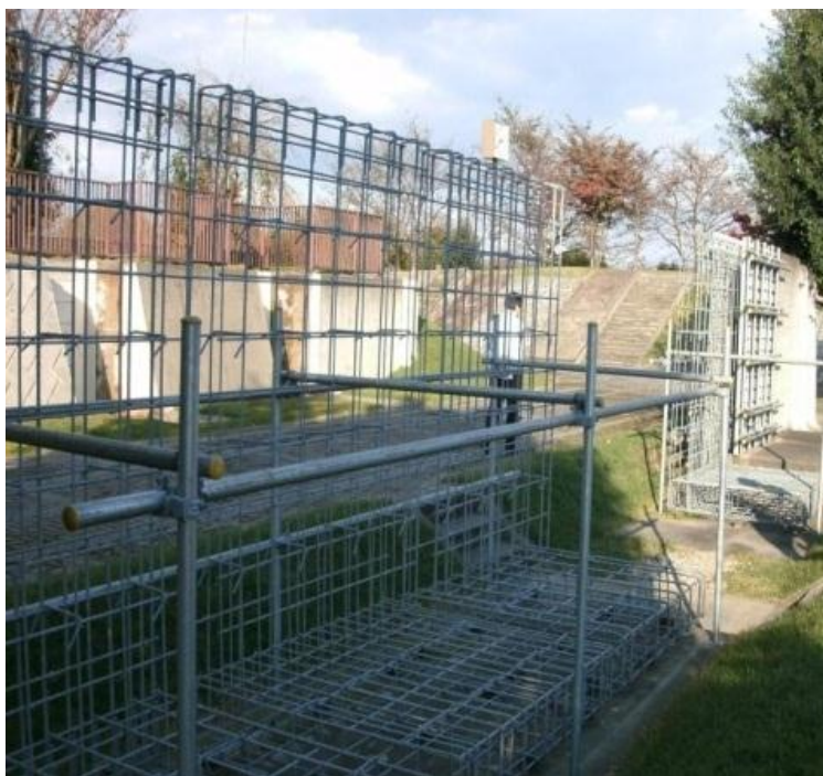
写真 4-3 擁壁配筋模型（実物大）
