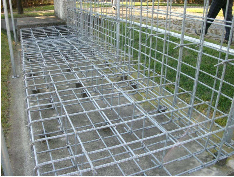
写真 4-4 擁壁配筋模型（実物大）
