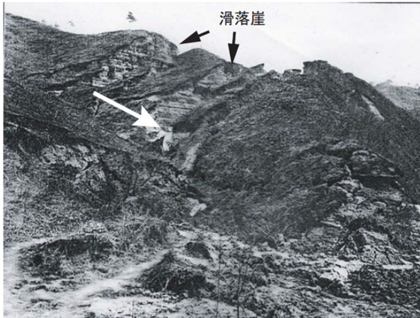
写真 3.2 1914 年仙北地震による上戸沢地すべり（尾根を寸断する岩盤並進すべり）
