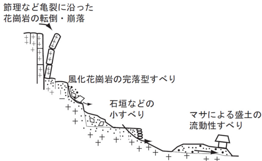
図 3.4 花崗岩類分布域における地震地すべりの形状
