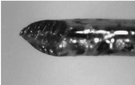
Fig. 2(a) 機械研磨で作製した Pt/Ir 探針. (直径 0.25mm)
