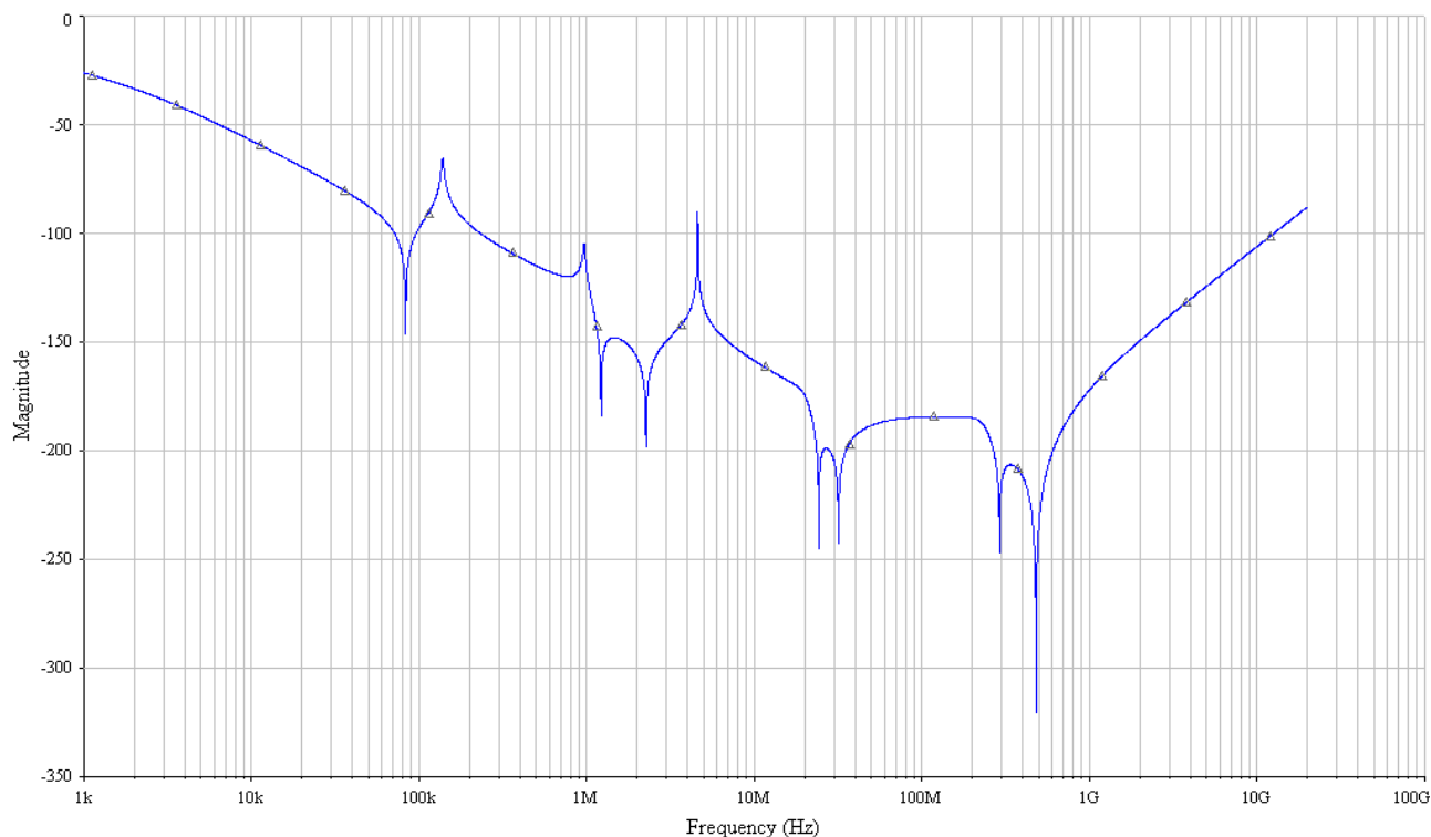
Рисунок 2.4 – Внесене загасання фільтра типу ФМПЗЗ-1-10
