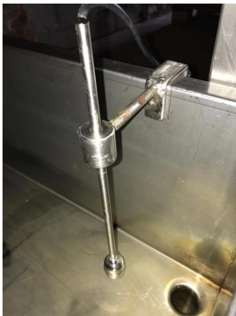
Slika 5.1: Plovec, nameščen na krnico
