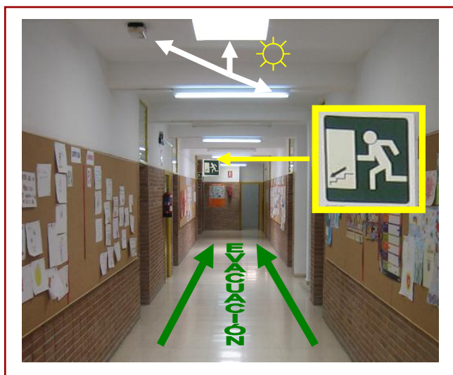
FIGURA 13. Vía de evacuación expedita, con señales de dirección de salida e iluminación con luz natural (vanos de iluminación cenital) y artificial (incluida emergencia).
