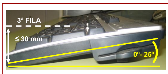
FIGURA 34. Adecuada disposición del teclado en los equipos informáticos.
