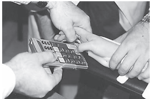
Figura 4.- Inicialmente se comprobó la acción de Rocío con su dedo pulgar sobre las teclas del Teclado Numérico. Posteriormente se probaron férulas estandarizadas y se acabó acoplando el teclado numérico al reposabrazos de su silla de ruedas.
