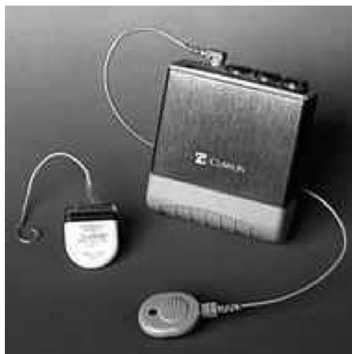
Figura 4. Componentes del implante coclear
