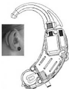
Figura 1. Imagen transversal de un audífono retroauricular
