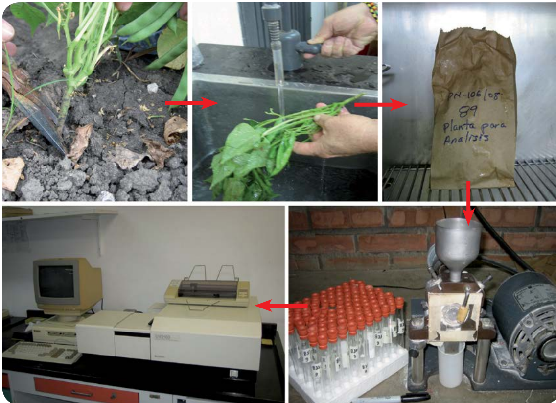
Figura 9. Corte, lavado, secado y molición de la planta adicional para el análisis de nutrientes.
