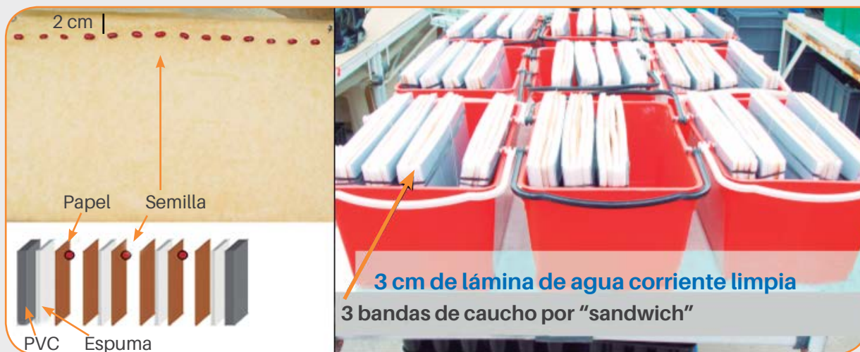
Figura 2. Germinación de semillas de frijol ( Phaseolus sp.) en un sistema de emparedado para la evaluación y selección de genotipos por resistencia a niveles altos de aluminio. A la izquierda, la colocación de las semillas sobre el papel de germinación humedecido y un emparedado donde se usa una lámina de PVC de 3 mm de grosor, espuma "espumflex calibre 23 blanco", papel de germinación. A la derecha la colocación de emparedados dentro de bandejas con lámina de agua corriente de 3 cm.
