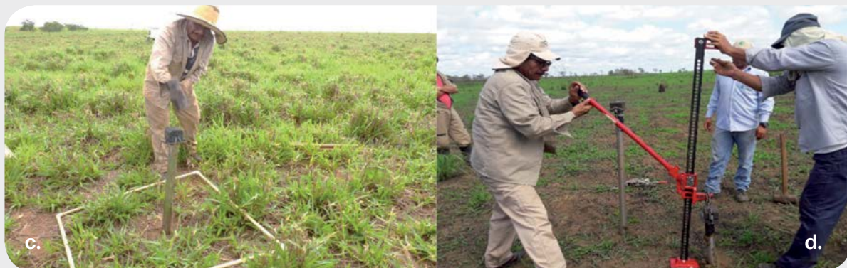
(c) Ubicación del marco de muestreo de 1 m 2 (1x1 m) e introducción del tubo en el suelo; (d) extracción del tubo con muestra de 1 m de profundidad.
