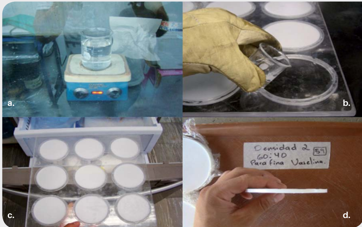
Figura 3. Elaboración de discos de parafina: a) calentar a 80 °C de la parafina dura (60%) y blanda (40%) por 15 minutos; d) dispensar la mezcla sobre el molde de los discos; c) refrigerar a 7 °C los discos de parafina durante 20 minutos; d) disco de parafina.
