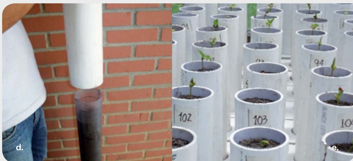
Figura 2. Formación de la unidad experimental : a) diagrama de la distribución del suelo en el cilindro; b) llenado inicial de cilindro con suelo sin compactar; c) colocación de la capa compactada sobre el suelo; d) cubrimiento del cilindro con tubo de PVC; e) distribución en invernadero de los tratamientos en gradillas de madera.
