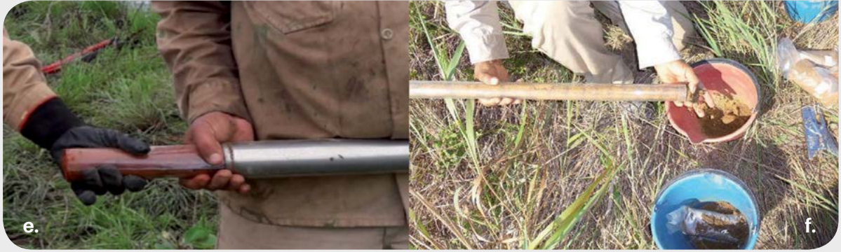
(e) Separación de submuestras del tubo por profundidad predefinida; (f) colocación y homogenización de las muestras de los cinco puntos de muestreo de cada marco separadas por profundidad.
