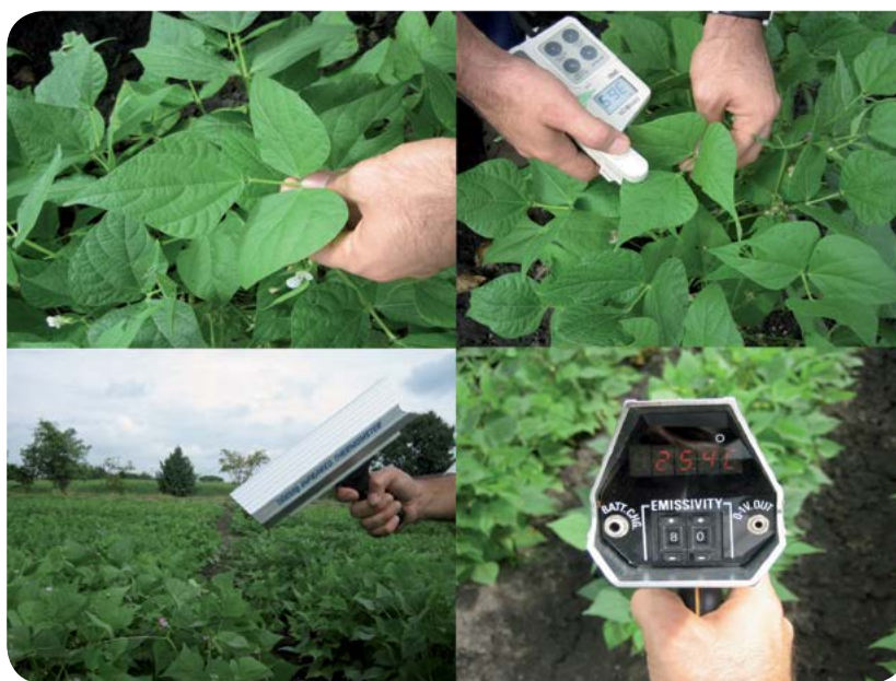
Figura 5. Medición del contenido de clorofila en una hoja joven completamente expandida (medidor SPAD - 502) y de la temperatura del follaje con termómetro infrarrojo (Telatemp modelo AG-42D) bajo condiciones de campo.
