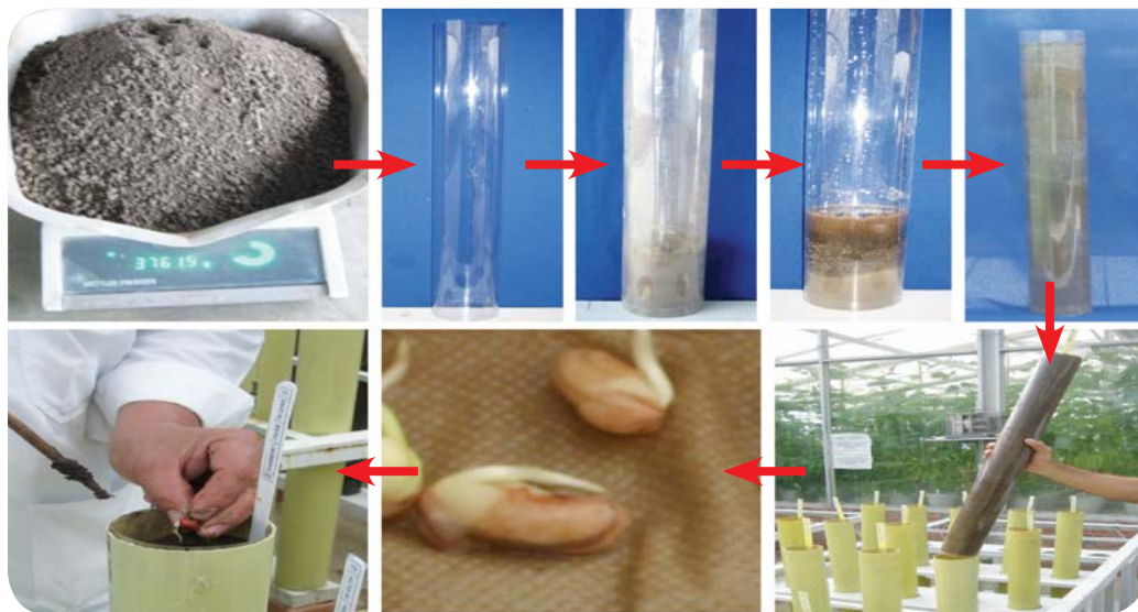
Figura 14. Metodología para llenar cilindros con la mezcla de suelo - arena, germinación de semillas y trasplante a los cilindros.
