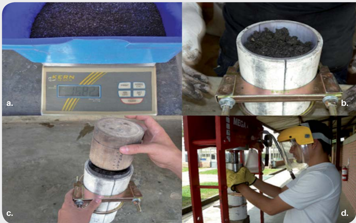
Figura 1. Elaboración de la capa de suelo compactada: a) pesaje y humedecimiento del suelo; b) ubicación de la muestra de suelo en molde; c) empuje inicial de la muestra; d) sostenimiento a presión de la muestra con prensa hidráulica.
