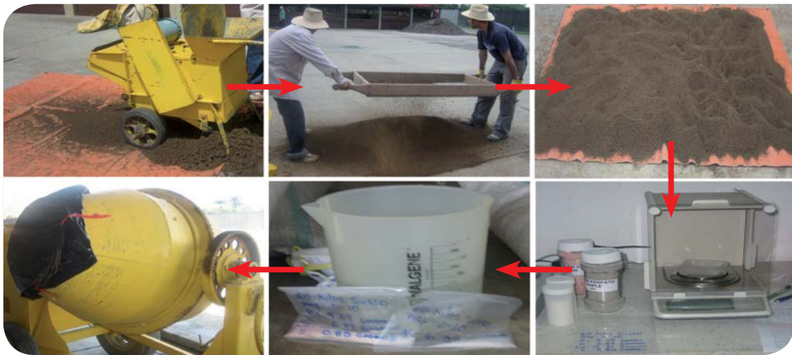
Figura 13. Proceso de homogenización, molienda, tamizado y fertilización del suelo para el llenado de cilindros.
