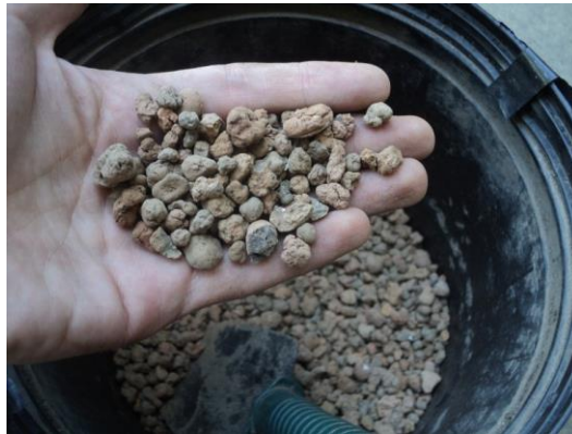
Figura 30: pedres per drenar.
