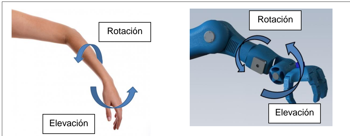
Ilustración 87: Comparación movimientos brazo humano y robótico
