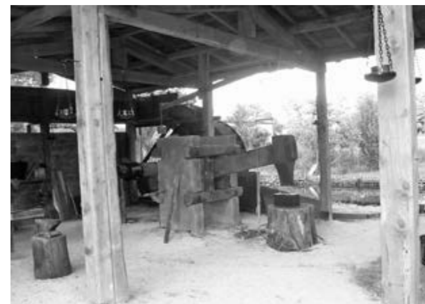
fig. 2 Bevagna, Mercato delle Gaitte 2008, ricostruzione di una ferriera a metodo diretto: la ruota ad acqua e il maglio
