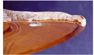
Fig. 10 - Particolare delle colature di vetrina sulla superficie di frattura.
