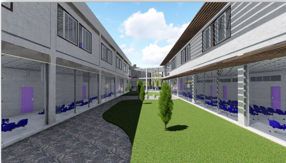
Figura n° 48: Vista de Patio interior para mejor la óptima ventilación y climatización, elementos de control solar horizontales (pérgola) y ventanas con láminas de control solar.
