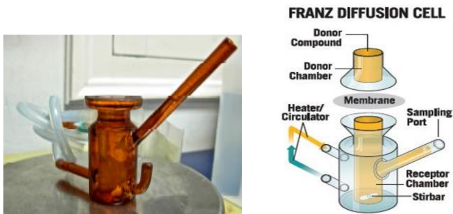
Figura 28. Imagen de la celda de Franz (izquierda) y esquema de los componentes de una celda de Franz (derecha).
