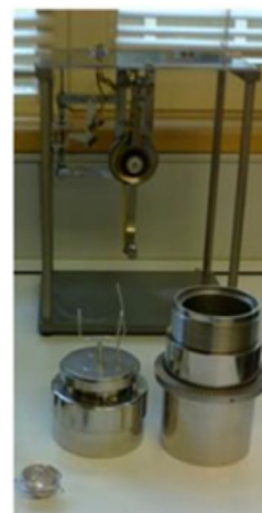
(atrás) Suporte da bomba rotativa; (à frente da esquerda para a direita) Cadinho de platina, cabeça da bomba e corpo da bomba.
