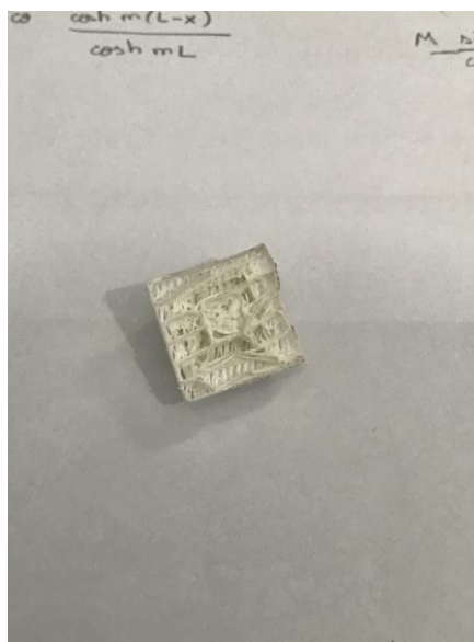
Figura 43 – Peça com defeito parte inferior
