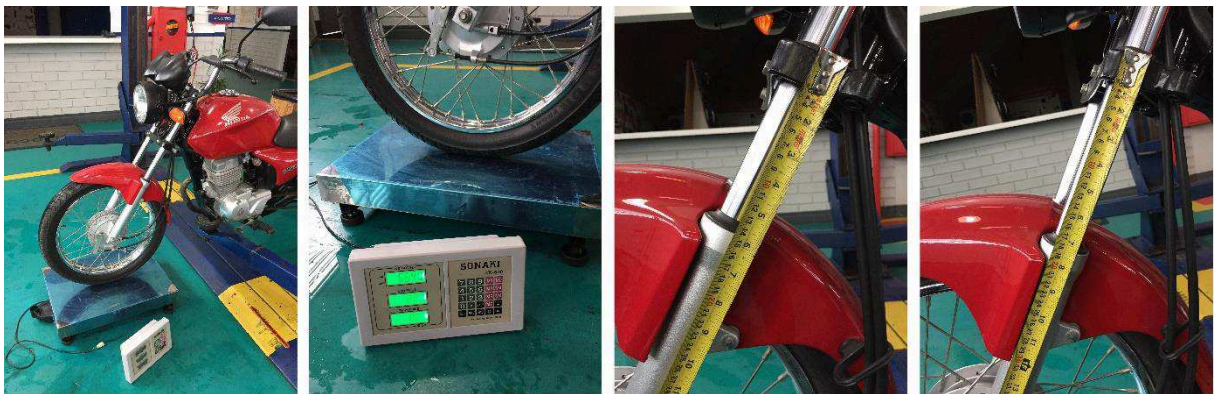
Figura 30 - Procedimento para cálculo da rigidez vertical do eixo dianteiro.
