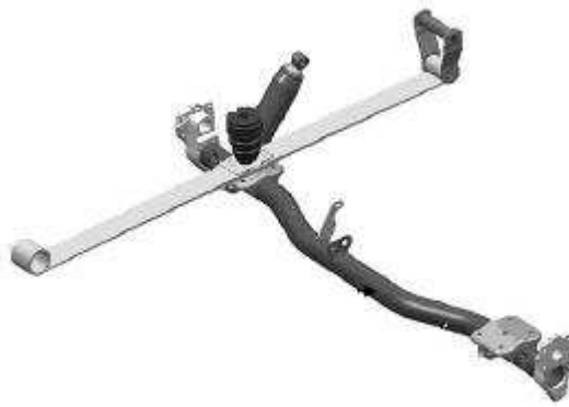
Figura 4 - Suspensão dependente do tipo Eixo Rígido com fecho de mola
