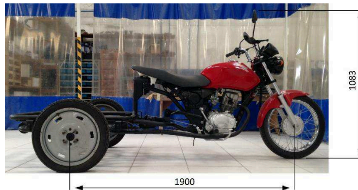
Figura 10 - Dimensões do protótipo. Altura e distância entre eixos evidenciadas.
