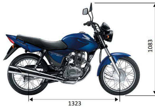
Figura 9 - Dimensões originais da motocicleta utilizada no projeto do triciclo estudado.
