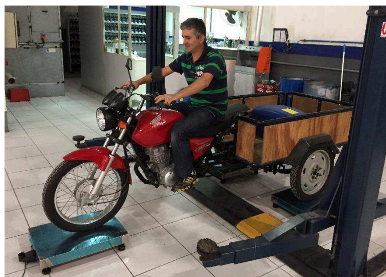
Figura 27 - Protótipo sobre balanças para o cálculo da localização longitudinal do CG.
