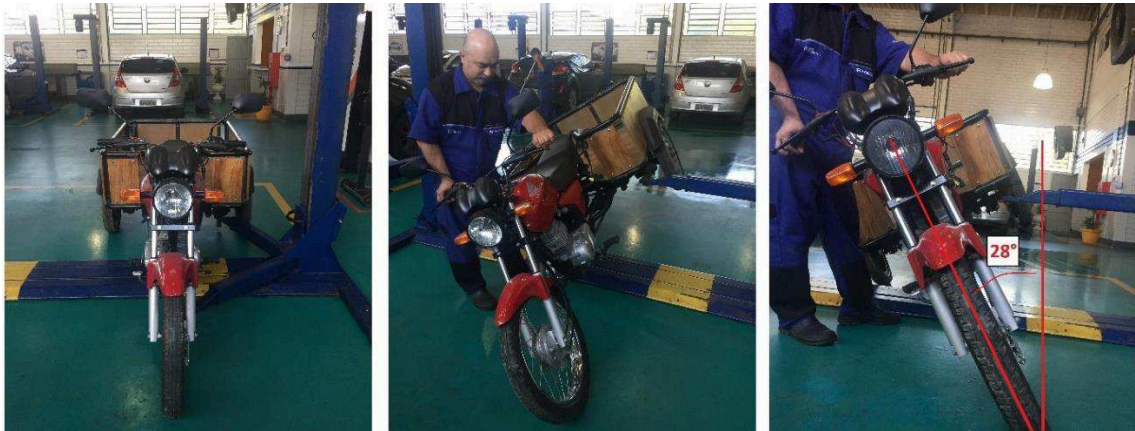
Figura 35 - Procedimento para cálculo do ângulo lateral máximo devido ao tombamento.
