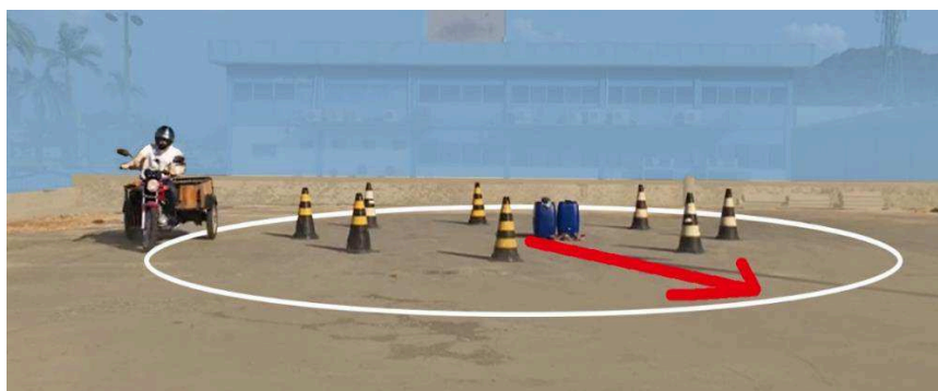
Figura 36 - Teste do raio constante realizado com o protótipo.
