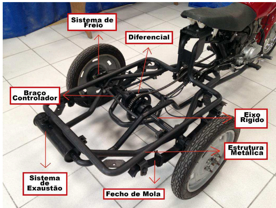
Figura 8 - Identificação das partes constituintes do módulo.
