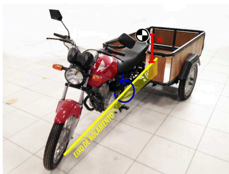
Figura 32 - Ilustração do eixo de rolamento do protótipo de 3 rodas.
