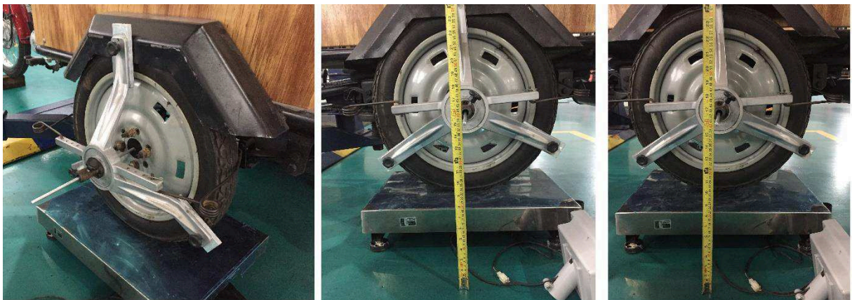
Figura 31 - Procedimento realizado para obter a rigidez vertical do eixo traseiro.
