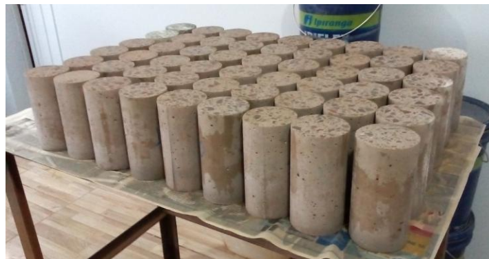
Figura 13: Corpos de prova retificados e preparados para o rompimento.
