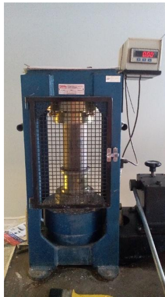
Figura 14: Prensa hidráulica utilizada na ruptura do concreto.
