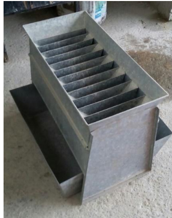
Figura 7: Separador mecânico utilizado
