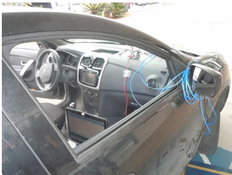
Figura 13 – Instrumentação do veículo.
