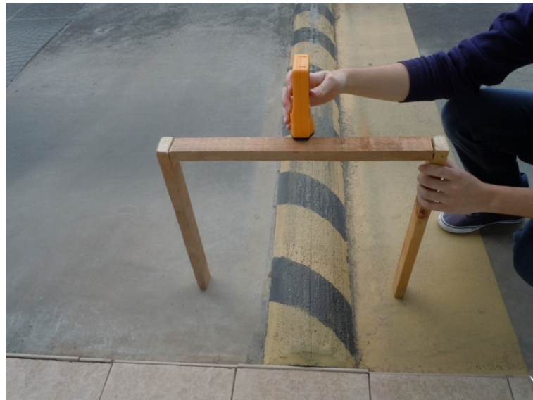
Figura 6 – Medição da lombada.
