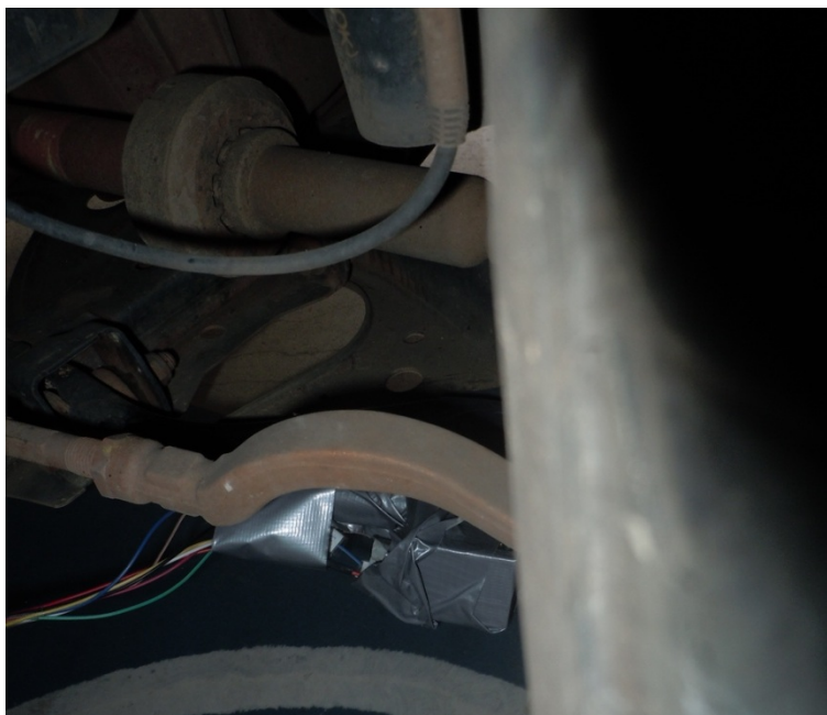
Figura 12 – Acelerômetro posicionado na massa não suspensa.
