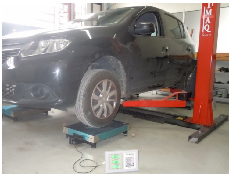
Figura 16 – Procedimento para a obtenção das forças nas molas.
