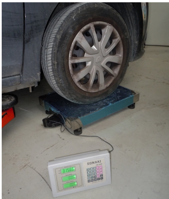
Figura 17 – Obtenção da força na mola dianteira direita.
