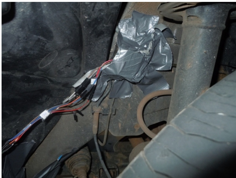
Figura 11 – Acelerômetro posicionado na massa suspensa.
