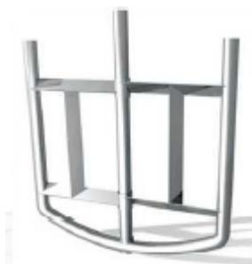
Figura 9 - Impelidor tipo ancora (QUEIROZ, 2009).
