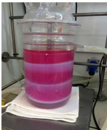
Figura 37 – Vórtice formado no teste de agitação.
