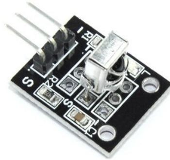
Figura 44 - LED receptor Infravermelho IR KY-022. Fonte: (FILIPEFLOP, 2017).
