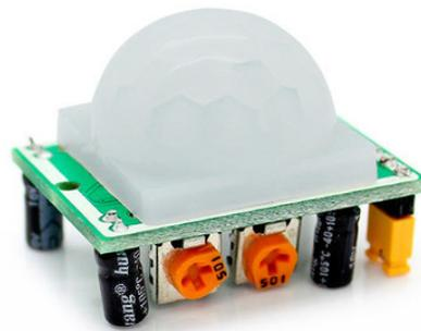
Figura 39 - Sensor de movimento/presença. Fonte: (FILIPEFLOP, 2017).
