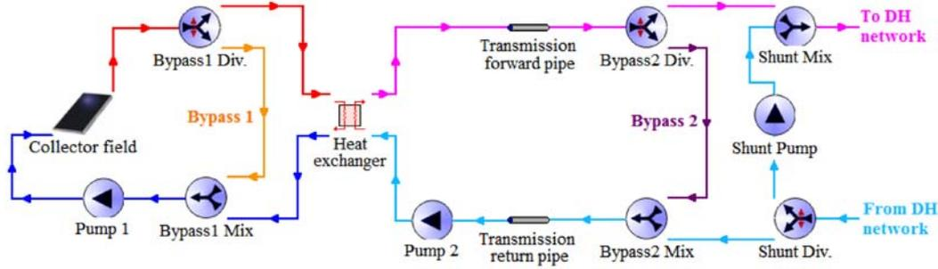
Figure 4.1: Scheme of Høje Taastrup solar heating plant.
