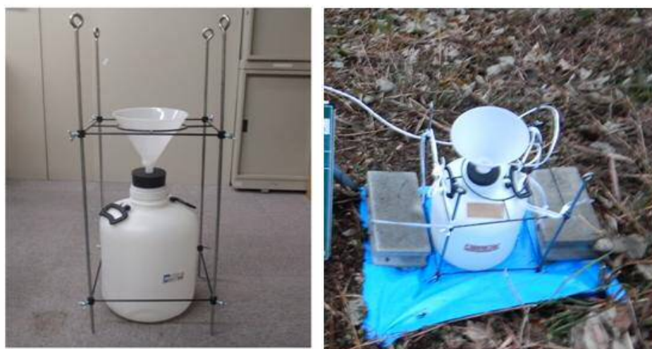
写真-3.6 飛散塩分捕集器 (デポジットゲージ)
