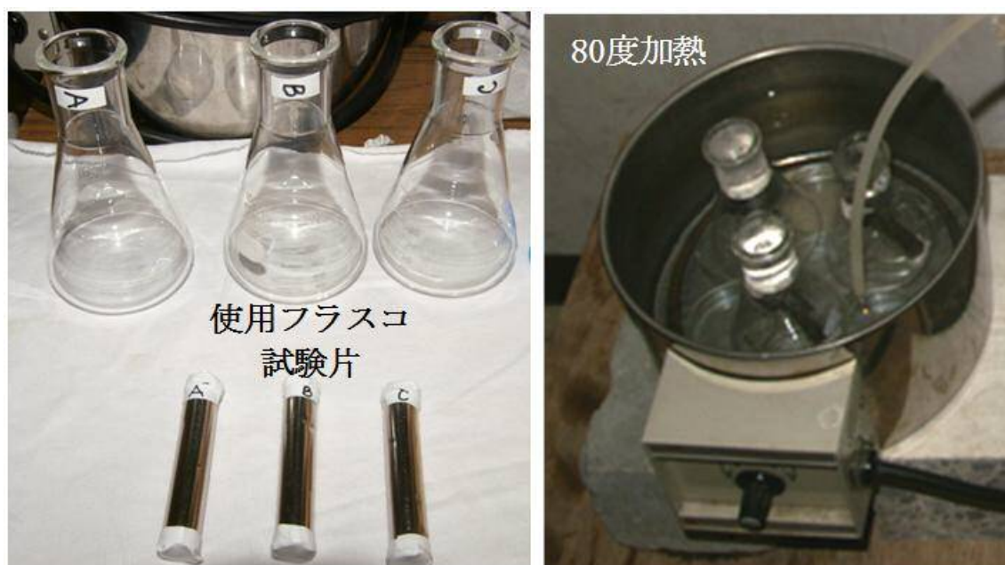
写真-6.4 高温水による腐食促進試験の器具と試験片
