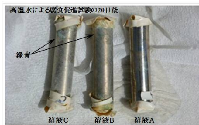
写真-6.7 電熱ヒーターの腐食状況
