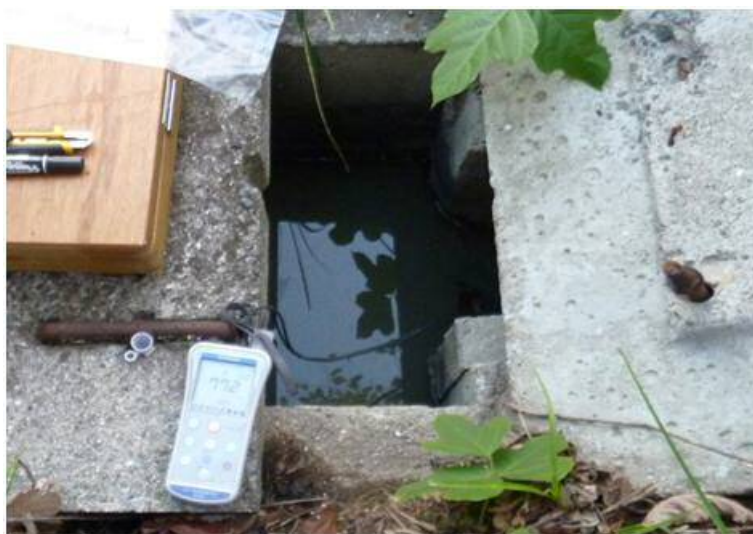
写真-7.3 電気伝導計での測定状況
