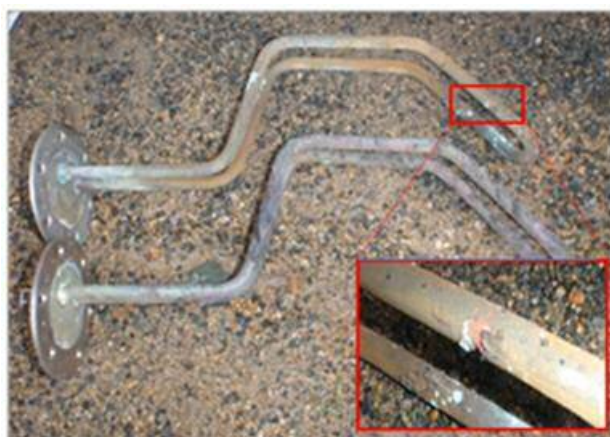
写真-2.7 電気温水器の電熱棒腐食
