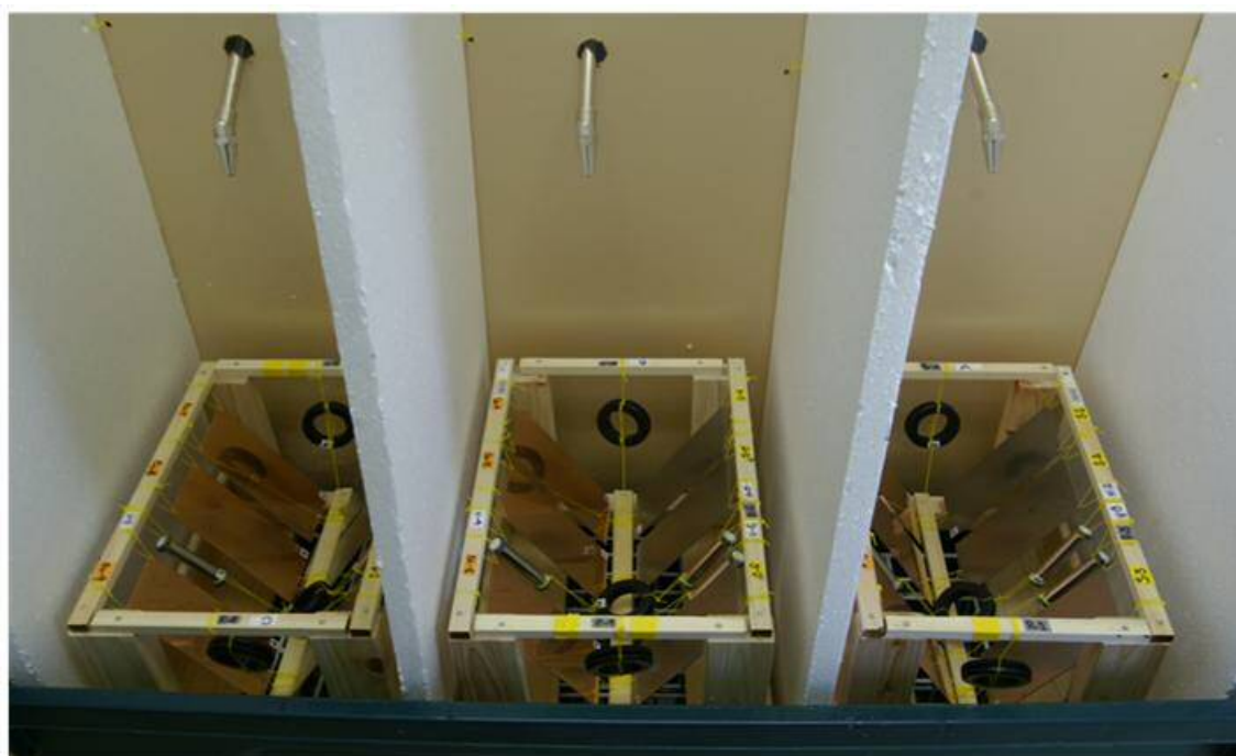
写真-6.3 塩水噴霧試験の状況
