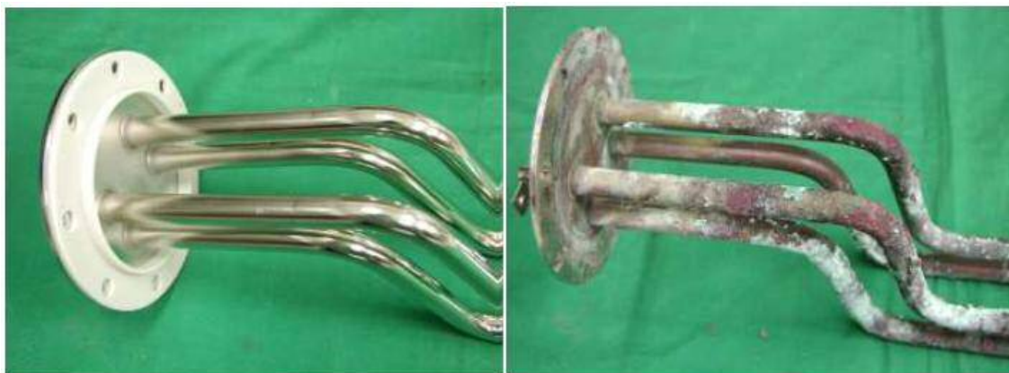
写真-6.1 電熱ヒーターの腐食状態（右）（左：新品）
