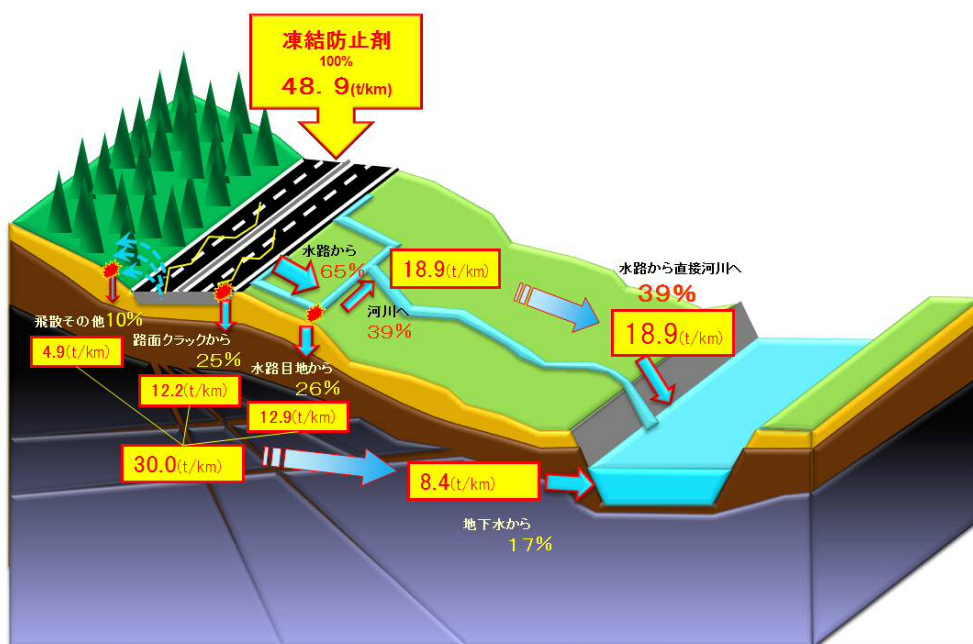
図-3.21 凍結防止剤の地下水への浸透経路図 9)
