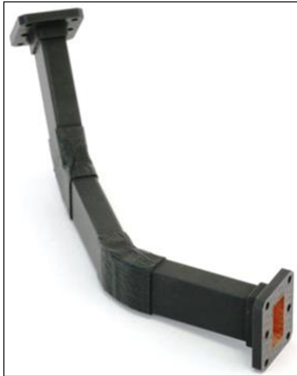
Figure I-16. Guide d'ondes en composite polymère, dont la surface interne a été métallisée avec un film de Cu par MOCVD.
