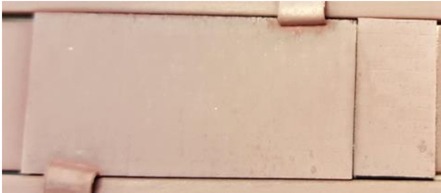
Figure IV-17. Photographie d'un dépôt Cu,Co/RTM6(O 3 ) déposé à T_d = 140 °C.
