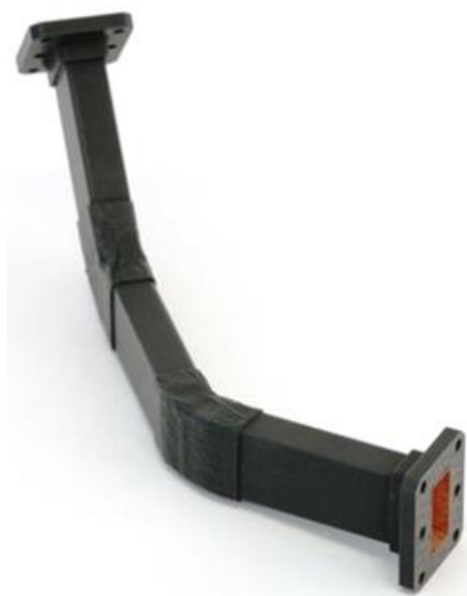
Figure V-3. Guide d'ondes en composite polymère, dont la surface interne a été métallisée avec un film de Cu par MOCVD. © Mecano ID, CIRIMAT.
