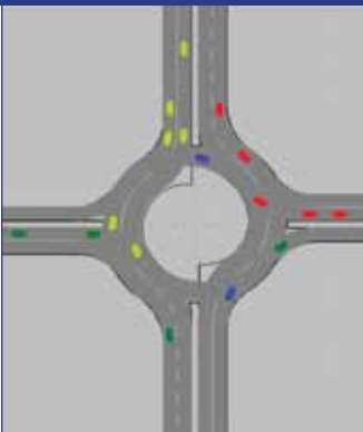
4. ábra: Körforgalom 2 - turbó körforgalom R1 = 12 m
