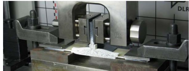
BILD 23. Versuchsaufbau für die Stringerproben
