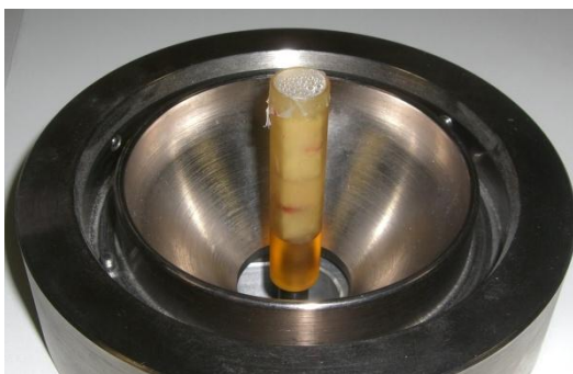
Abb. 12 Probenröhrchen mit vier Knochenstückchen im MicroCT
