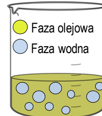
Rys. 7. Schemat emulsji typu w/o.
