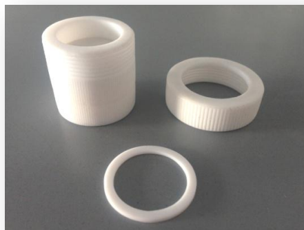
Rys. 35. Teflonowe komory ekstrakcyjne wykorzystywane w badaniach kinetyki uwalniania substancji.
