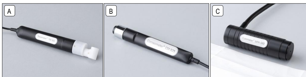
Rys. 24. Tewametr (A), korneometr (B) oraz kutometr (C) firmy Courage - Khazaka (zadaptowane z [256]).
