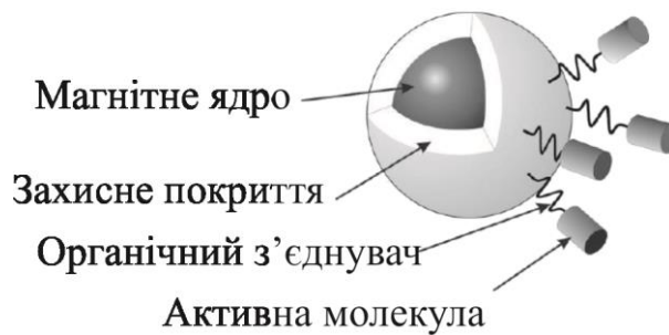
Рисунок 1.4 – Схематичне зображення функціоналізованої магнітної наночастинки. Із роботи [18]
