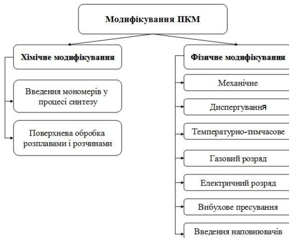
Рисунок 1.2 – Схема основних методів модифікування ПКМ на основі ПТФЕ
