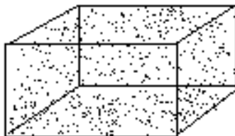
Рисунок 4.4 – Структура двокомпонентного матеріалу на основі політетрафторетилену, армованого дисперсними частинками
