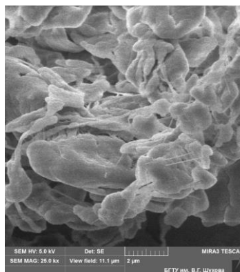
Рисунок 3.2 – Структура ПТФЕ до (а) та після (б-е) механічної активації
