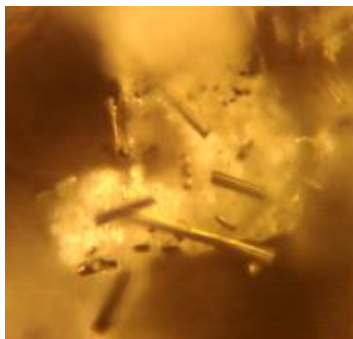
Рисунок 3.13 – РЕМ-мікрофотографія вуглепластику, виготовленого за двостадійним режимом (x200)
