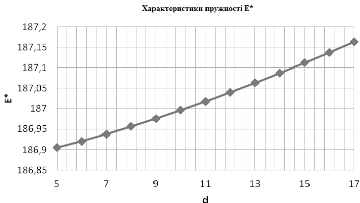
Рисунок 4.12 – Залежність модуля Юнга композита від діаметра волокна
