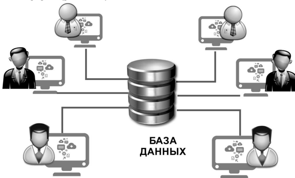
Рисунок 6.1.2 - Централизованная модель хранения данных
