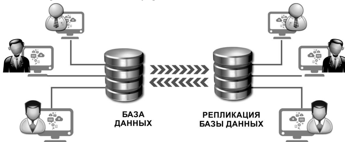
Рисунок 6.1.3 – Централизованная модель хранения данных с репликацией
