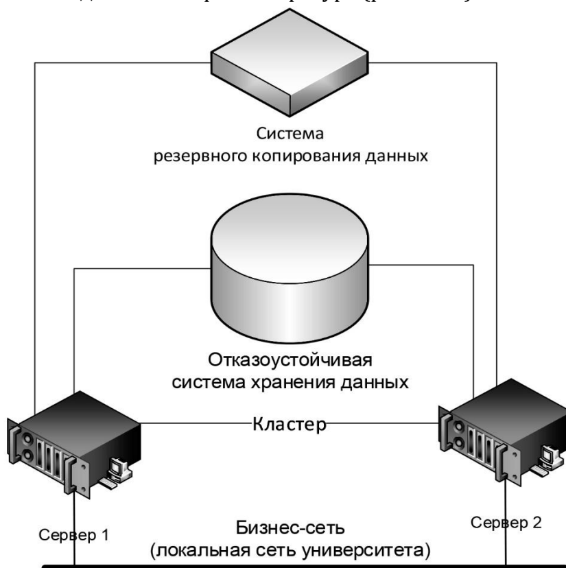
Рисунок 6.4.1 – Архитектура простейшего отказоустойчивого кластера
