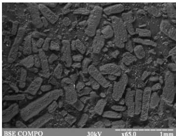
Рисунок – Електронно-мікроскопічна фотографія подрібненого ПЕЕК на дробарці МРП-1 (час подрібнення  $\tau = 10$  хв., число оборотів робочих органів дробарки  $n = 7000$  об/хв.)
