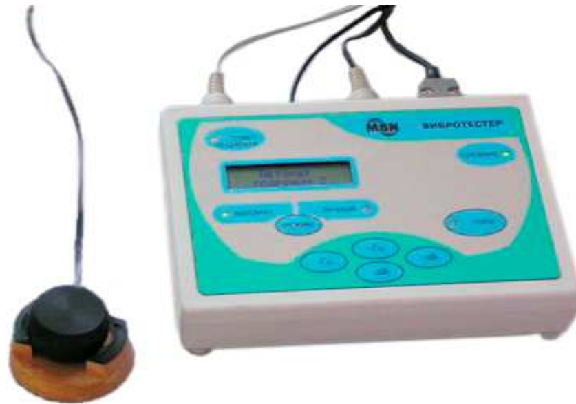
Малюнок 5.1 – Прилад вібротестер VT-02-1 «ВІБРОТЕСТЕР-МБН»
