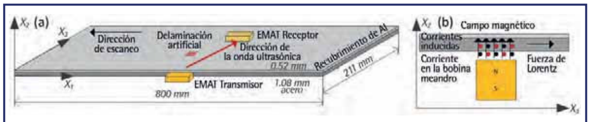
Figura 5. Transductores EMAT utilizados para la generación y recepción de ondas guiadas propagando en un material con delaminaciones artificiales. a) Diagrama del experimento. b) Interacción entre campos magnéticos que influyen en la generación del ultrasonido
