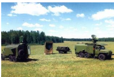
Рисунок 20 – Радіопеленгаційний метеорологічний комплекс: 1Б44 «Улыбка»: а – на марші; б – на позиції
