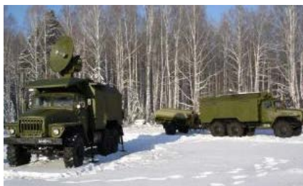
Рисунок 20 – Радіопеленгаційний метеорологічний комплекс: 1Б44 «Улыбка»: а – на марші; б – на позиції
