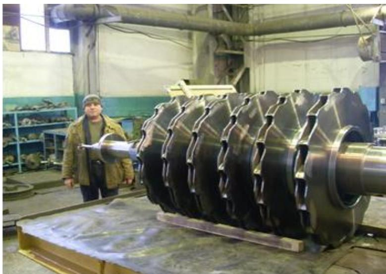
Рисунок 1 - Многоступенчатый ротор высокооборотного центробежного компрессора газоперекачивающего агрегата.
