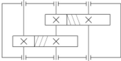
Рисунок 1 - Кинематическая схема двухступенчатого цилиндрического зубчатого редуктора
