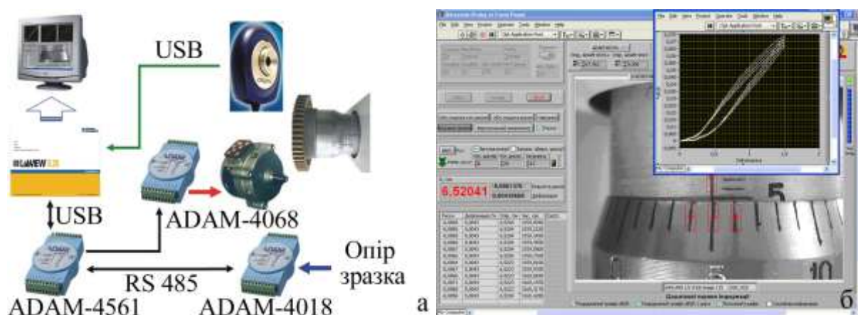
Рисунок 2.3 – Структурна схема автоматизованої системи дослідження тензоефекту (а) та інтерфейс програмного забезпечення (б)
