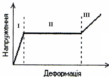
Рисунок 4 – Залежність напруження від деформації для кристалічного лінійного полімеру
