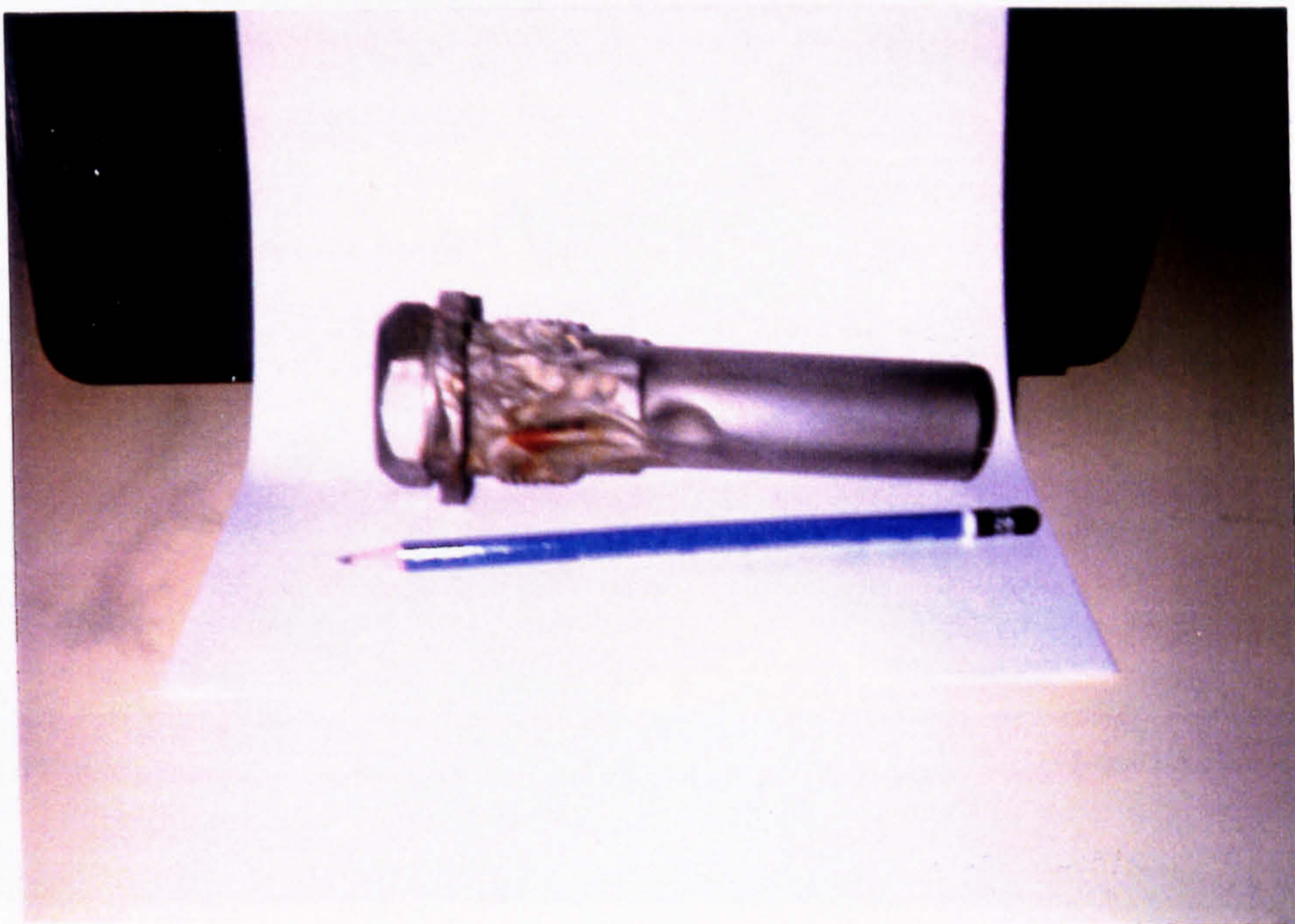
(d) 24/64 Permanent choke severely eroded.
