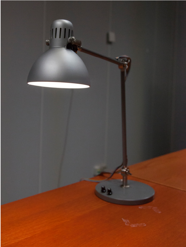
Figur 2 Ny arbejdslampe der indgår i det intelligente dynamiske belysningsystem. Lampen er med computer eller manuel styring af lysets styrke og farvetemperatur. Indgår i brugertest som arbejdspladsbelysning.
