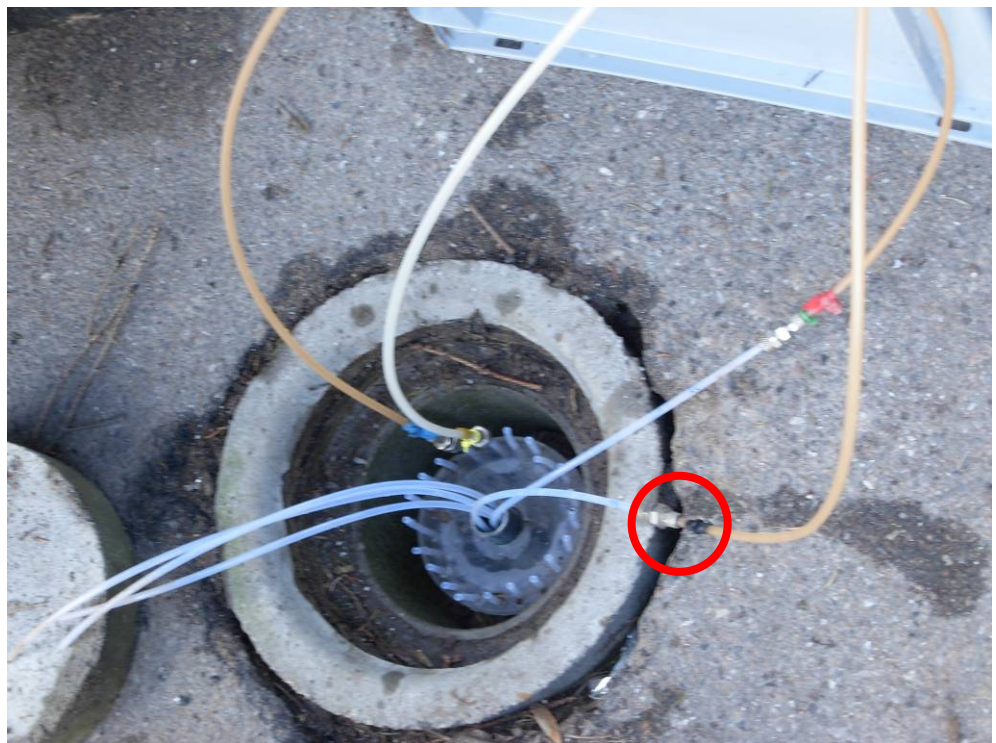
Figur 1: Øverst: installering af MLS. Hver slange svarer til 1 filter. Nederst: MLS prøvetagning. Den røde cirkel markerer forbindelse mellem MLS slanger og slanger til prøvetagningsudstyr.
