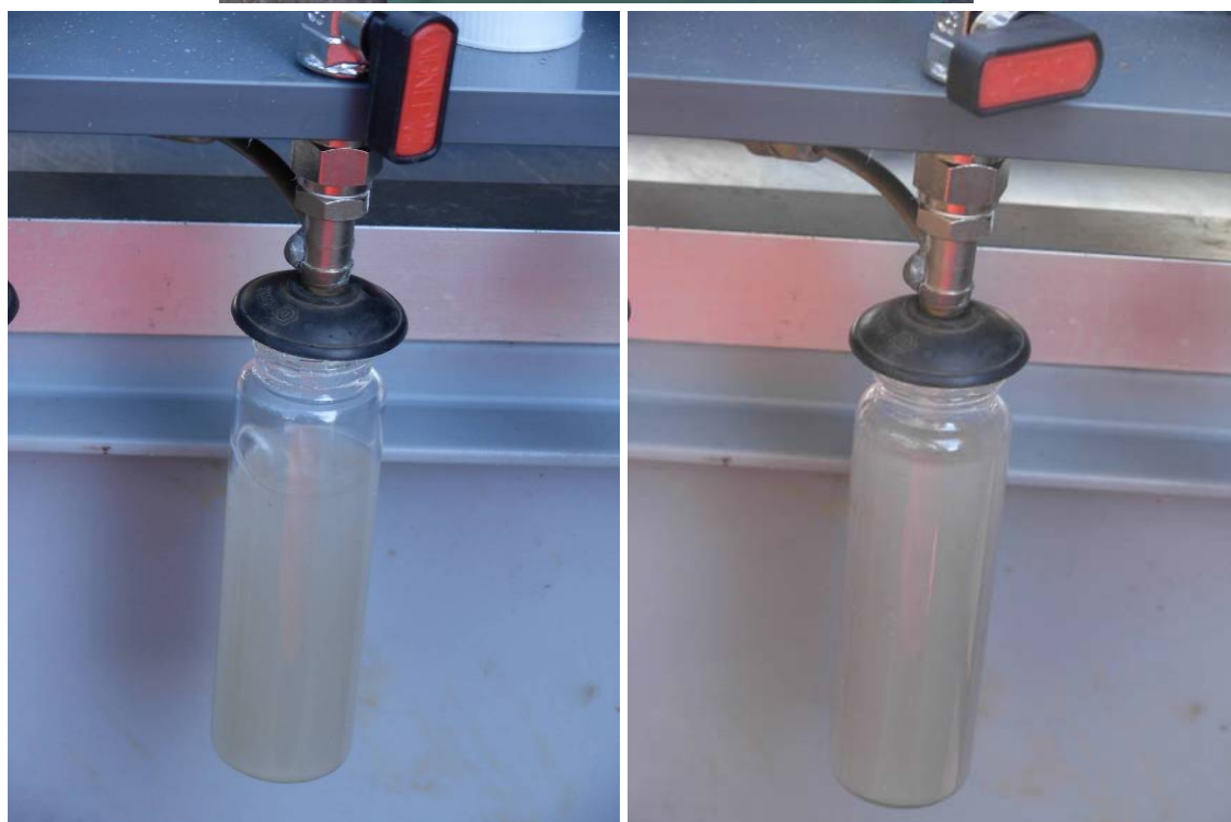
Figur 3: Øverst: Prøvetagningsudstyr med vacuum-måler og 1 prøvetagningflaske i gang. Renspumpningsvolumen: 40 ml. Nederst: Prøvetagning til 40 ml glas vials (samme som brugt til F-boringer) med så lidt headspace som muligt (helt uden headspace er ikke muligt pga. vacuum).
