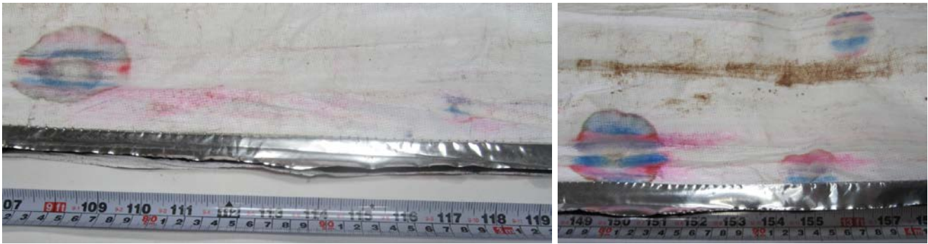
Figur 29: Eksempler på farvemarkerings på NAPL membran fra CTF2. Til venstre ses tydelig plet ved 2,70-2,78 m u.t. og utydelig farvemarkerings ved 2,96-3,00 m u.t. Til højre ses en plet ved 3,78-3,85, og to pletter ved 3,91-3,99 m u.t.
