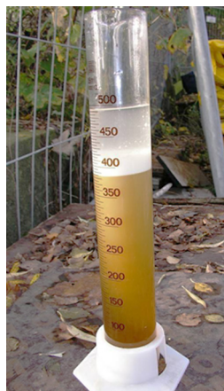
Foto af DNAPL og vand udtaget fra boring filtersat i formation med mobil PCE DNAPL på lokalitet i Skuldelev.
