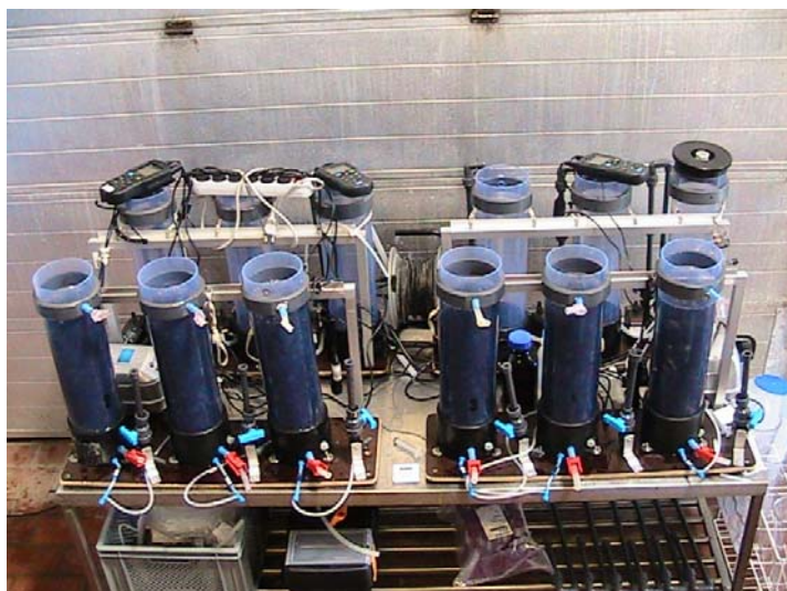
Foto af opstilling med reaktorrør indeholdende biofilterelementer.
