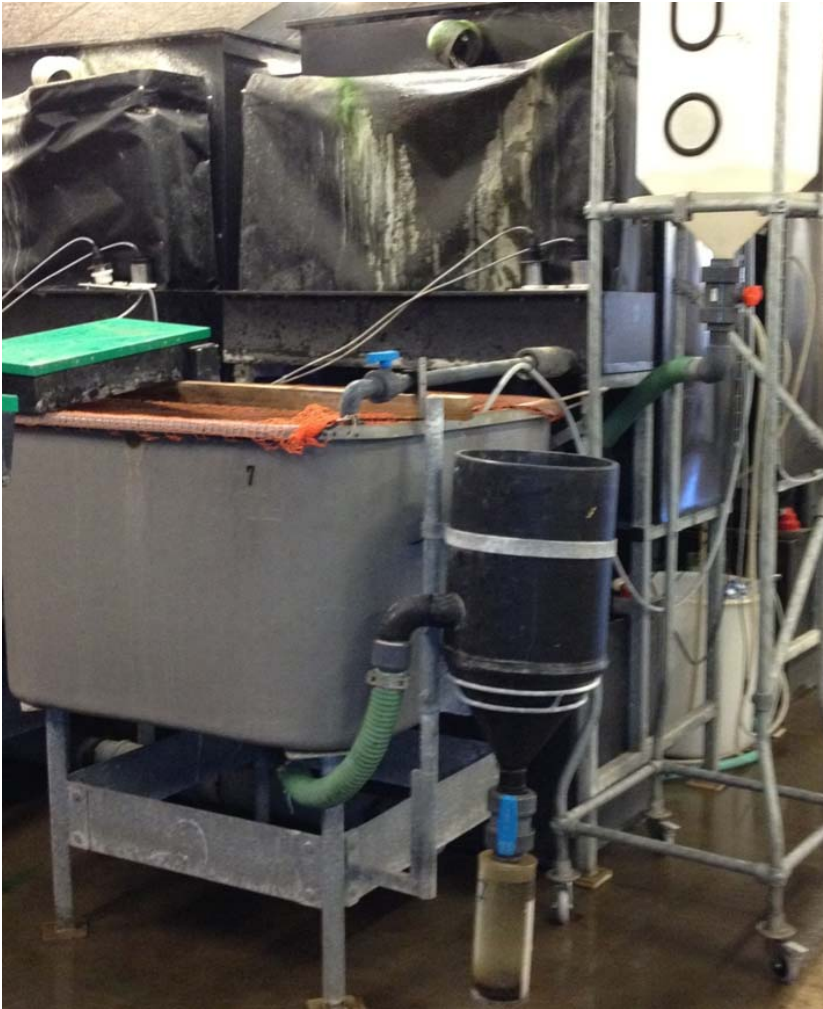
Figur 2.1. Et af de recirkulerede fiskeanlæg, som blev brugt i forsøgene. Nederst under hvirvelseparatoren ses opsamlingsbeholderen til fækalier.
