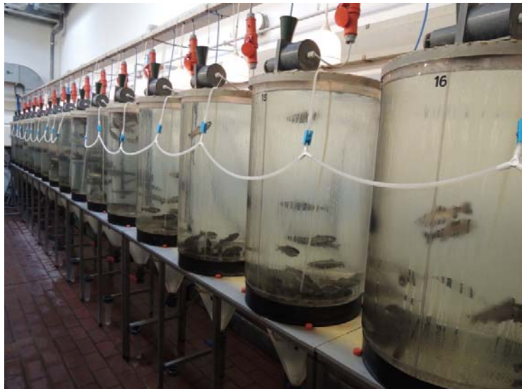
Figur 4.3. Forsøgskarrene der blev anvendt til undersøgelse af effekter af gasovermætning på fordøjelighed, foderkonvertering og tilvækst.
