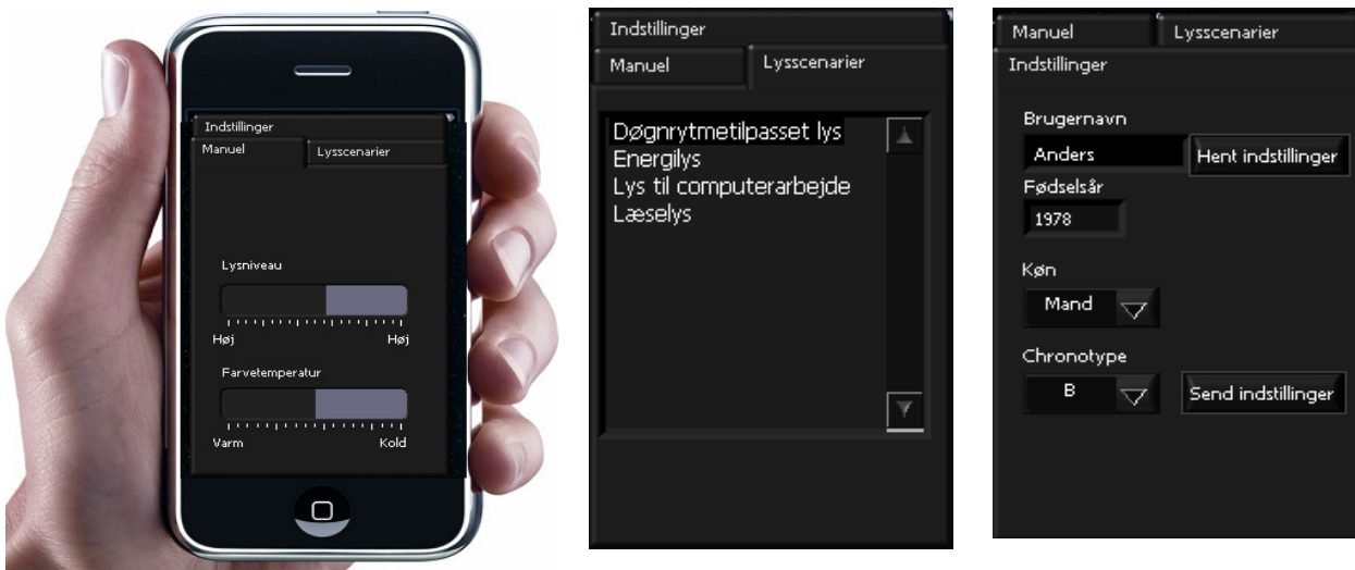
Figur 9 Viser det udviklede brugergrænseflade med tre faneblade for hhv. manuel styring, præinstallerede lysscenerier og personlige indstillinger.
