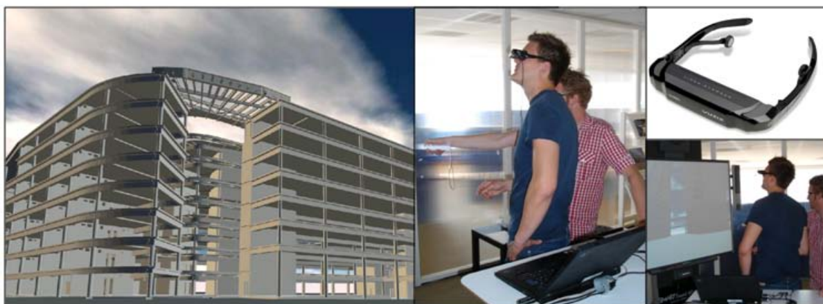
Fig. 5: Figuren viser et eksempel på modelbaseret brugerinvolvering gennem at anvende et Virtual Reality setup, så de kommende brugere gennem animationer og VR kan træffe beslutninger vedrørende deres fremtidige arbejdsplads. Kilde: Rambøll.
